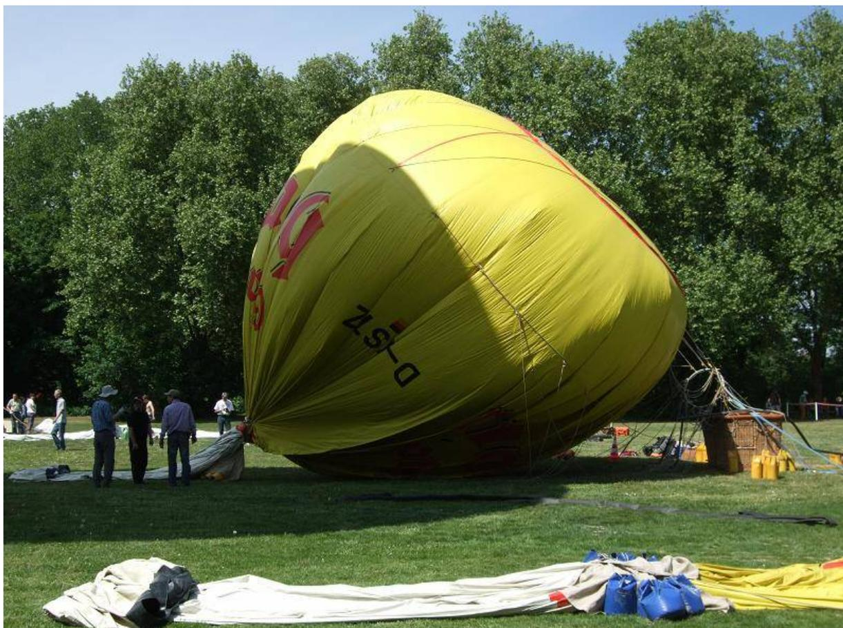
**Abbildung 12.** Kugelballon mit abgebundenem und niedergehaltenem Top bei der Befüllung.
